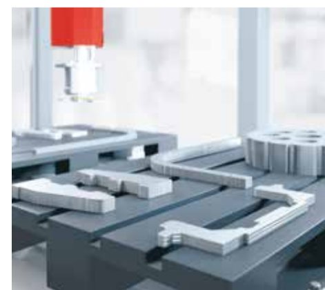
Třídění dílů na připravenou paletu! Automaticky, pro každý díl správný nástroj k uchycení.
